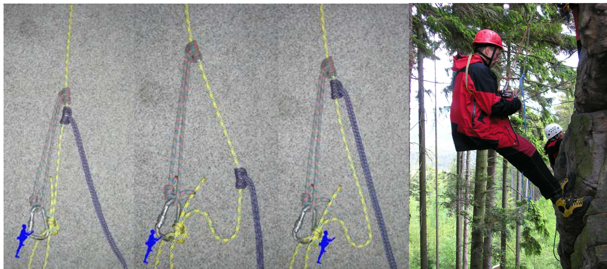
obr. 3 – prusíkování, první fáze – uspořádání smyček a prusíkování v terénu
