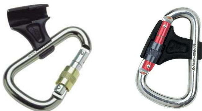
obr. 2 – DMM Belay master ( www.dmmclimbing.com ) karabina se šroubovací pojistkou zámku a plastovým překrytím zámku. Překrytí nelze zaklapnout při nezamčené karabině. Plast pak předělí karabinu na dvě části a je vyloučeno otevření zámku karabiny chybnou manipulací i zatížením karabiny v nevhodné ose
