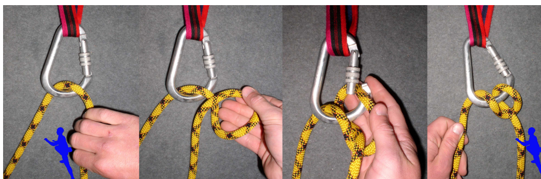
obr. 1 - zakládání lana do HMS, velmi důležitá je pozice volného konce lana při zatížení HMS lezcem a zajištění pojistky zámku (foto: R.Lienerth)
