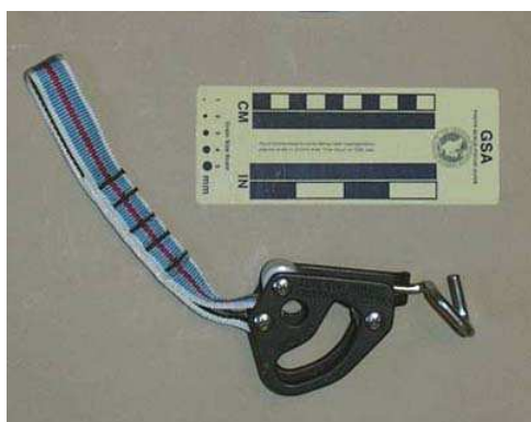
obr. 24 – Salewa Antz, první poloautomatická jistící brzda, dnes už muzejní kousek, umožňovala pouze jistění na jednoduchém laně
